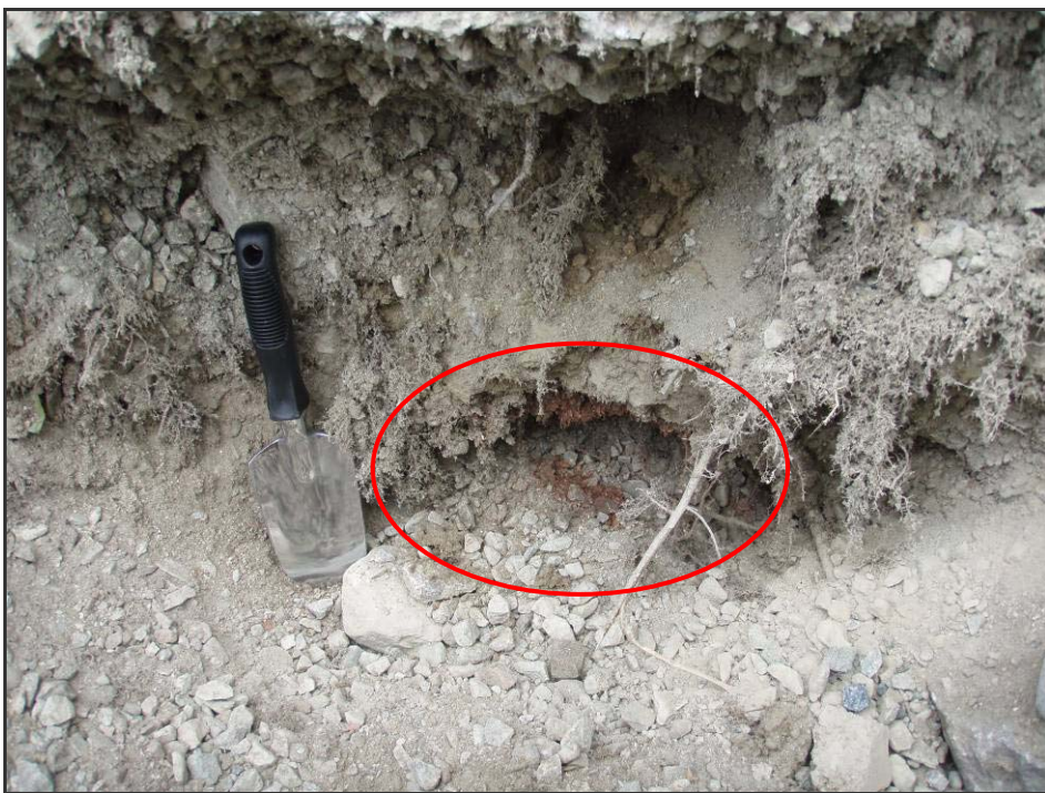
Bilde 2. Rustfarget lakk-/malingslaglag i PG.1.
