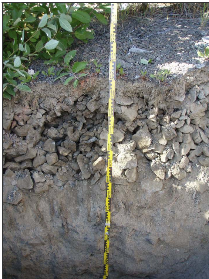
Bilde 15. Avrettingslag over sandige masser med grus i PG.5
